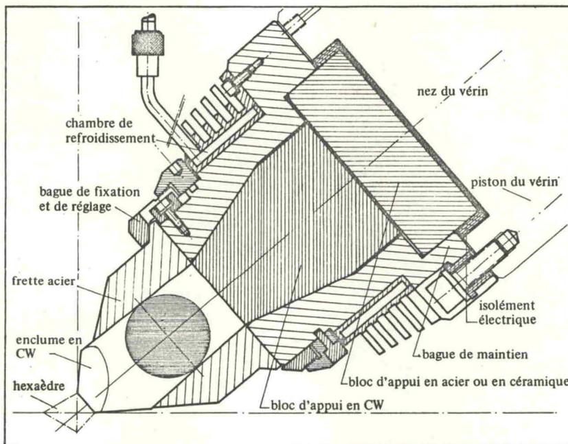
Figure 3. Schéma d'une enclume et de son support.
